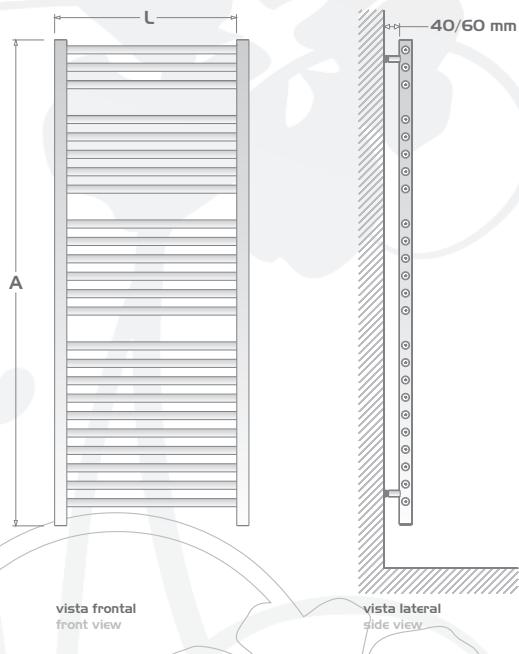
Toalheiro radiador composta por tubos horizontais circulares e verticais quadrangulares. Os elementos horizontais são em tubo Ø 20 x 1,5 mm acoplados a dois tubos verticais 30 x 30 x 1,5 mm.
